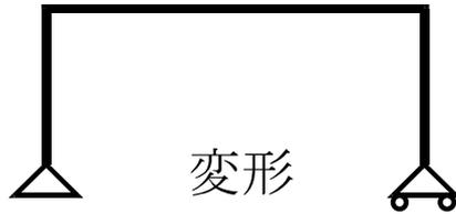
3. 下の構造物の M 図と概略の変形を描きなさい。ただし支点の水平反力は 2 kN と考えてよい。(2+2 点)
